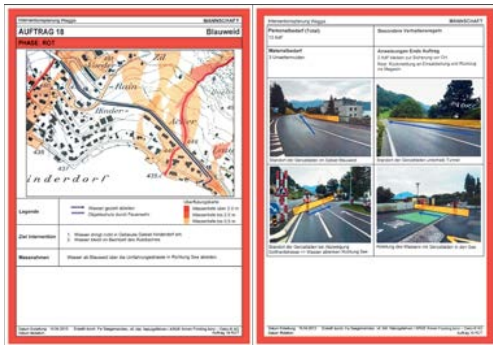
Slika 2: Navodila članom Civilne zaštite v kraju Weggis v kantonu Luzern (Švica) za konkretni ukrep na terenu v primeru intervencije ob poplavih: preusmeritev poplavne vode in preprečevanje vdora vode v objekte (levo); podrobno slikovno navodilo za izvedbo ukrepa, kjer sodeluje 12 članov civilne zaštite (desno).
